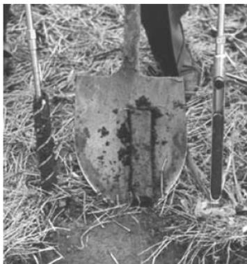
Si al obtener la muestra final, esta resulta demasiado grande, se debe mezclar convenientemente, y cuartear (separar en cuartos) hasta obtener una muestra de aproximadamente 2 kg.
